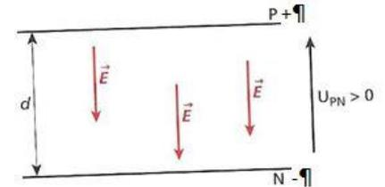
Fig.1. Représentation du champ électrostatique au sein d'un condensateur plan.
