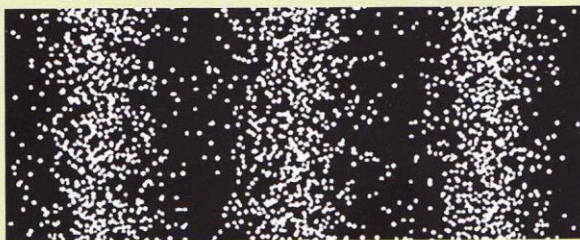
Doc. 3 Figure d'interférences obtenue avec des fentes d'Young bombardées photon par photon.
