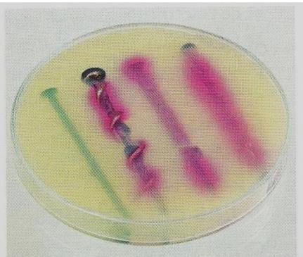
Données : La phénolphtaléine vire au rose dès que la solution devient basique par apparition d'ions hydroxyde  $\text{HO}^-$ .
