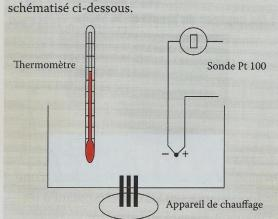
Pour chaque valeur de la température, on note la valeur de la résistance et on trace la courbe d'étalonnage du capteur; on obtient la courbe ci-après.
