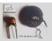
On a relevé les mesures de la résistance  $R_{th}$  d'une thermistance en fonction de la température T
